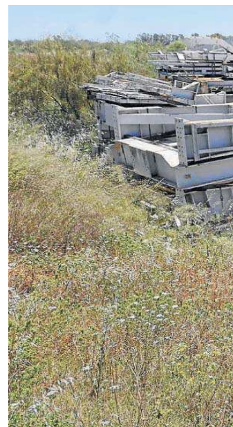
Piezas de la parte trasera de la tuneladora.
