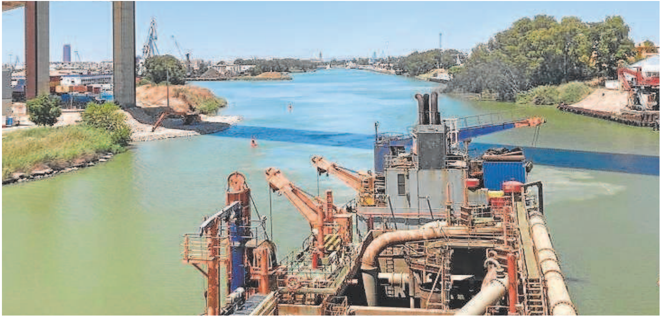
Uno de los barcos que están ejecutando el dragado de mantenimiento // DRAVO
