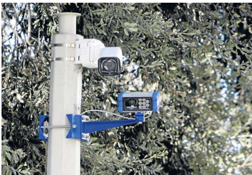
Detalle de las nuevas cámaras con analítica de vídeo que implanta la UTE Eysa-Aluvisa.
