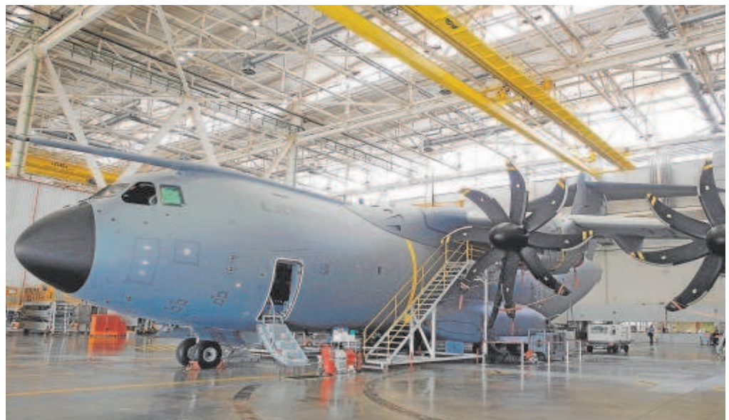
Montaje del A400M en las instalaciones que Airbus tiene en Sevilla // EFE/JULIO MUÑOZ
